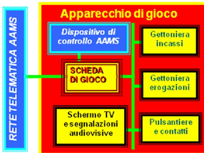
Fig. 1: Schema funzionale di un apparecchio di gioco
